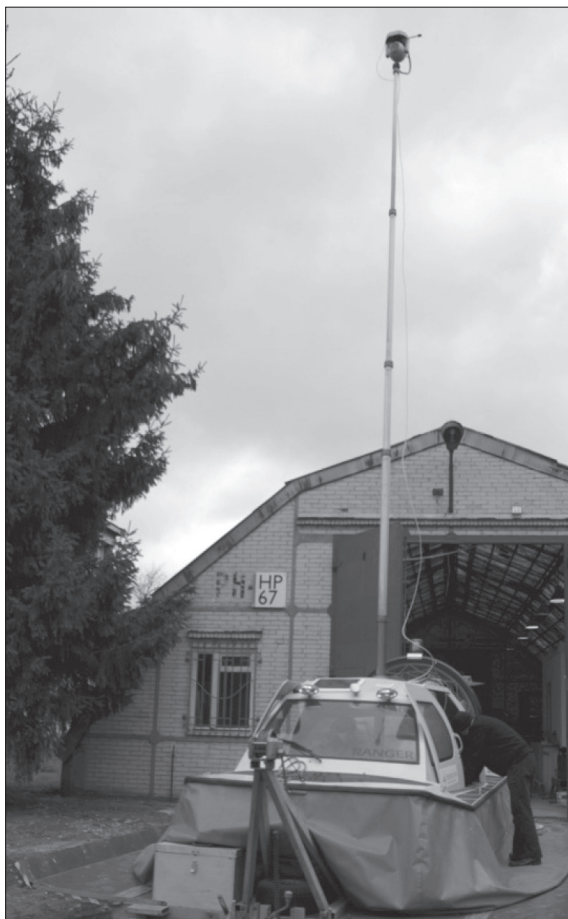
Rys. 8. Poduszkowiec PRC-600 z głowicą obserwacyjną GI-TEK na maszcie teleskopowym w trakcie prac integracyjnych w Instytucie Lotnictwa
