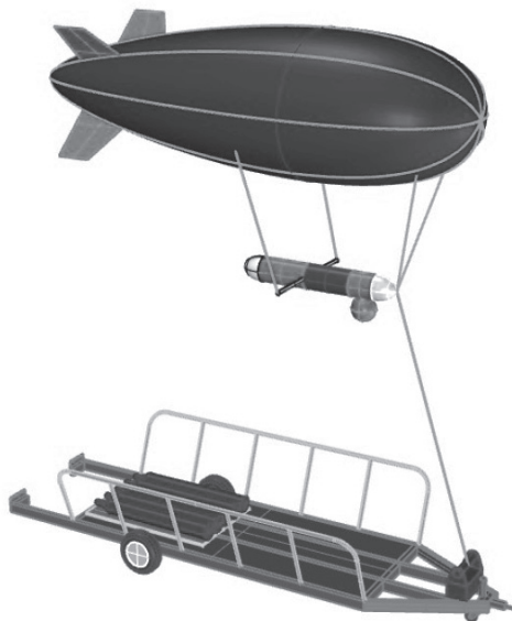
Rys. 9. Projekt koncepcyjny aerostatu na uwięzi z gondolą na osprzęt obserwacyjny
